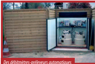
Des débitmètres-préleveurs automatiques réalisent les prélèvements d'eau en bas de pente des surfaces étudiées.
