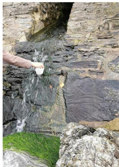
Les campagnes de prélèvement effectuées lors de l'élaboration des profils de vulnérabilité ont permis de mettre en évidence des écoulements/rejets ponctuels jusque-là inconnus (fuites de déversoirs d'orage non
